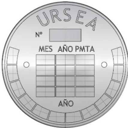
Figura: Esquema de la Placa de Registro del Generador de vapor de baja presión
